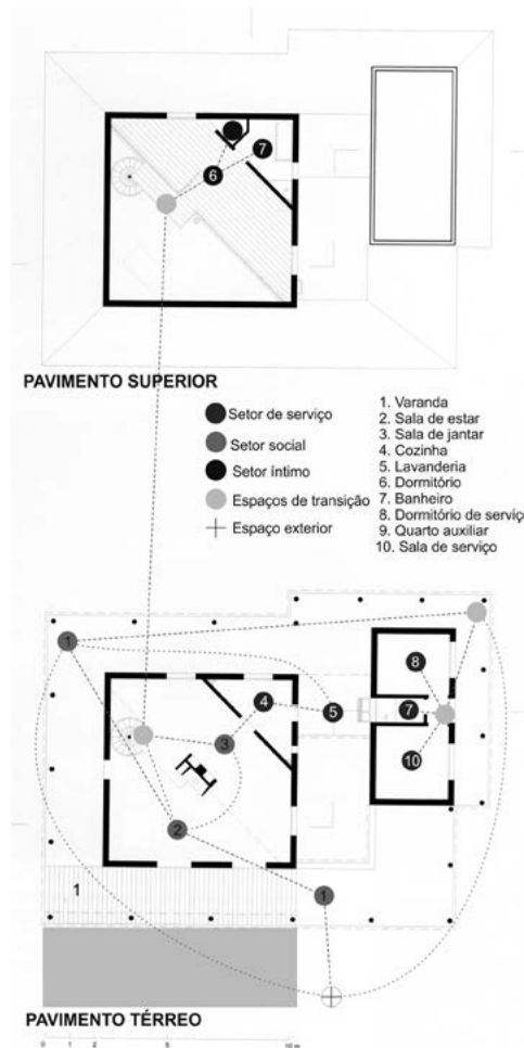
Figura 4. Planta baixa da Casa de vidro com indicação dos espaços convexos. Fonte: Oliveira, Lina Bo Bardi (p. 26), editado pela autora (2017).
