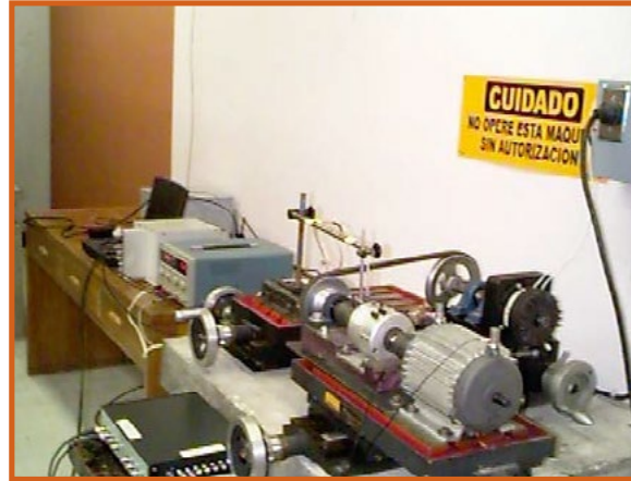
Fig. 3. Banco de pruebas acoplado a los sensores y al sistema de adquisición de datos
