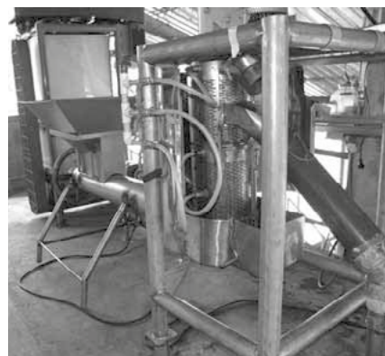
Figura 1. Dispositivo experimental utilizado en la evaluación del lavador de café en proceso con fermentación natural
