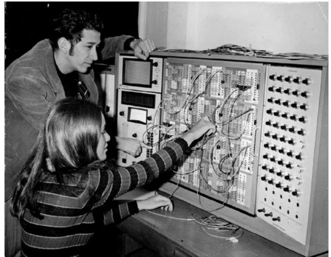
Foto 1 Computador análogo TR-48. Laboratorio de Ingeniería Electrónica. Edificio W.
